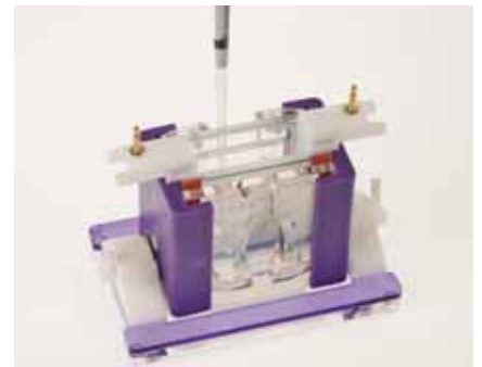
4. Proben applizieren und Elektrophorese durchführen.
