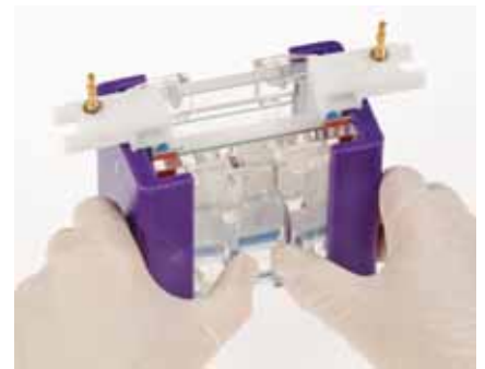
2. Glasplatten fixieren und Kammer auf dem Gießstand befestigen.
