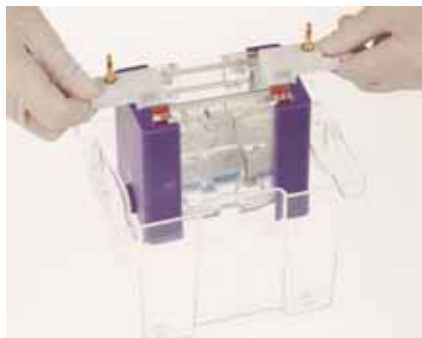
3. Mit Acrylamid auffüllen, auspolymerisieren lassen und in die Pufferbasis überführen.
