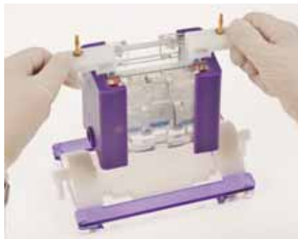
1. Kammer auf den Gießstand stellen und Glasplatten einlegen.
