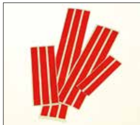
Gelträger und Kontraststreifen zum einfacheren Beladen der Gele
