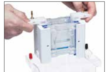
Den Gelträger in die Kammer einsetzen und das Gel für den anschließenden Lauf beladen
