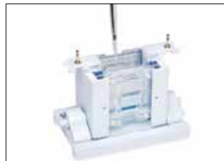
Die Polyacrylamidgellösung einfüllen, den Kamm einsetzen und auspolymerisieren lassen
