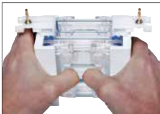
Glasplatten mit dem praktischen Klemmsystem im Gelträger fixieren
